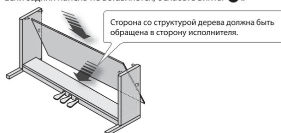
5. Прикрепите заднюю панель к металлическим скобам боковых панелей с помощью винтов A (4 × 14 мм). Чтобы задняя панель надежно встала на место, нажмите на верхние части боковых панелей.
