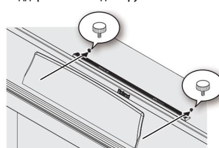
Устанавливая пюпитр, до упора сдвигайте его в сторону тыльной панели инструмента и одной рукой поддерживайте его, чтобы не уронить. Также следите за тем, чтобы не прищемить пальцы.
