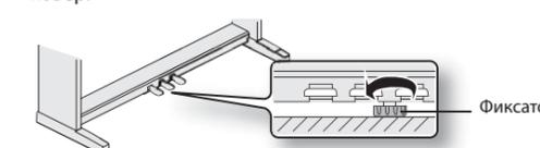
\* При наличии зазора между фиксатором и полом педали могут быть повреждены.
